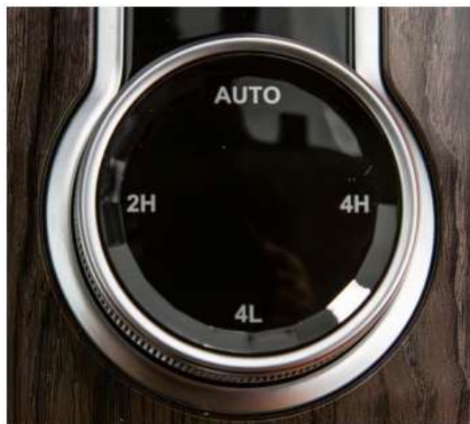
Inteligentní rozdělovací převodovka má čtyři režimy jízdy: 2H, AUTO, 4H a 4L. Pro výběr
