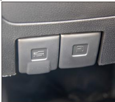
Otevřete kliku zámku krytu motorového prostoru, pákou otočte proti směru hodinových ručiček
