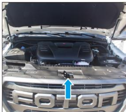
Otevřete kliku zámku krytu motorového prostoru, pákou otočte proti směru hodinových ručiček
