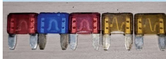
Výše uvedené jsou nepoškozené pojistky
